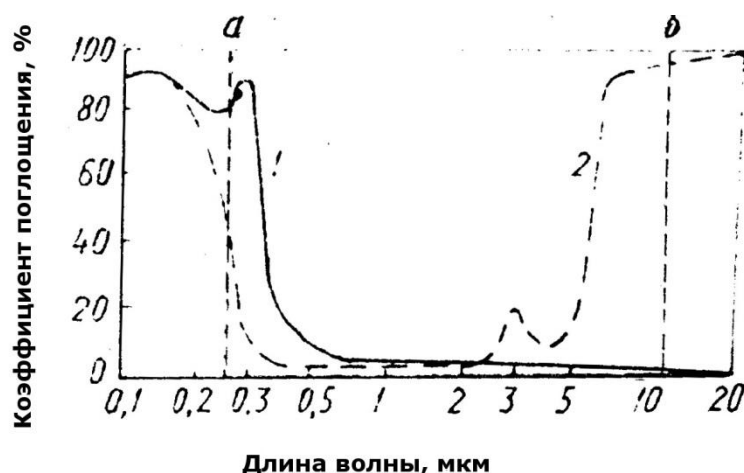
Рис. 10. График зависимости коэффициента поглощения от длины волны лазерного излучения для меди (1) и сапфира (2) при идеальном состоянии поверхности: а - криптоно-фторный лазер с максимальной мощностью 159 кВт и длиной волны излучения 248 нм; б - лазер на двуокиси углерода с максимальной мощностью 15 кВт и длиной волны излучения 10,60 мкм.
